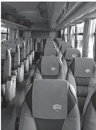
貸切需要が低迷する中、スポーツ選手輸送にも取り組む。スポーツ選手の体格に合わせ間隔を広げた座席シート
