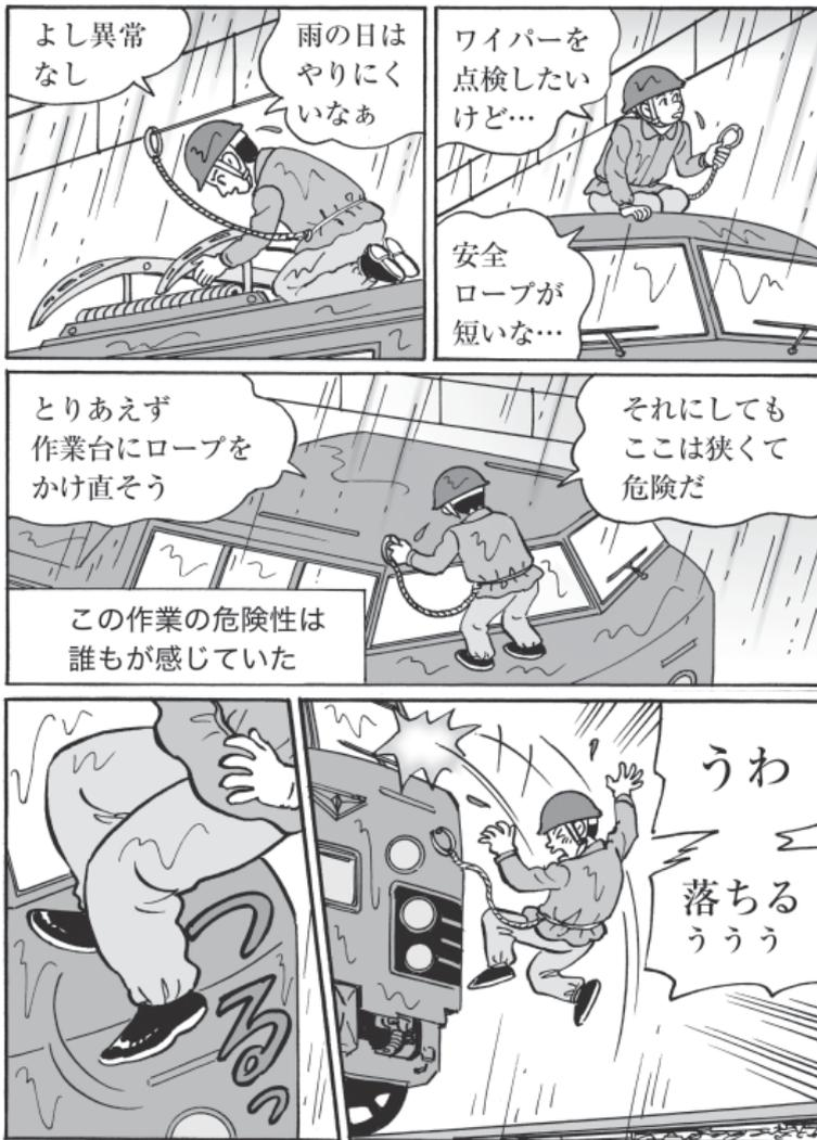
当該の作業員は、雨の中、基地構内で電車の仕業検査で屋根上のパンタグラフとワイパーの検査をしていました。
